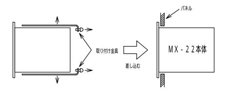
裏から取り付け金具で締め付け表示機を固定します。
