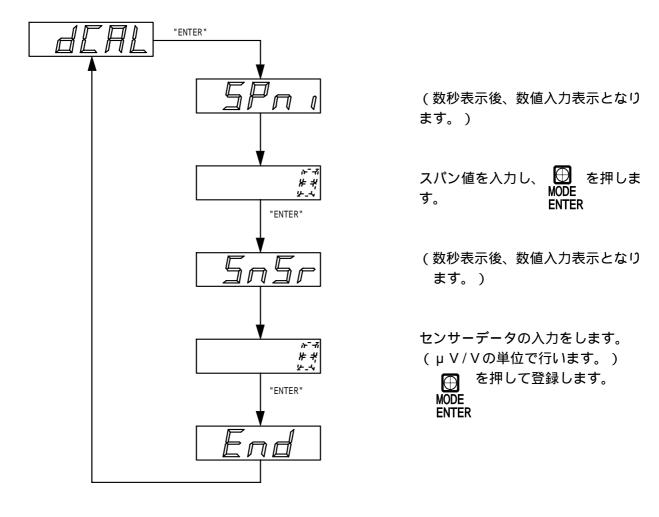
例 500Nのセンサーの出力が1.9875mV/Vである場合 スパン値を 500 センサーデータを 19875 と入力します。
