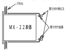
パネル取り付け用ビスは標準で ( $M3 \times 8$ ) を使用していますが、パネルの厚さが 2 mmを超えるものは取り付けビスを変更して下さい。
