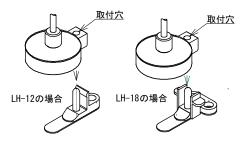
センサーの取付穴をホルダーの取付棒に合わせます この時ホルダーとセンサの向きを合わせて下さい
